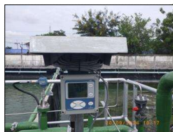
ระบบตรวจสอบคุณภาพน้ำแบบต่อเนื่อง (Online Monitoring)
